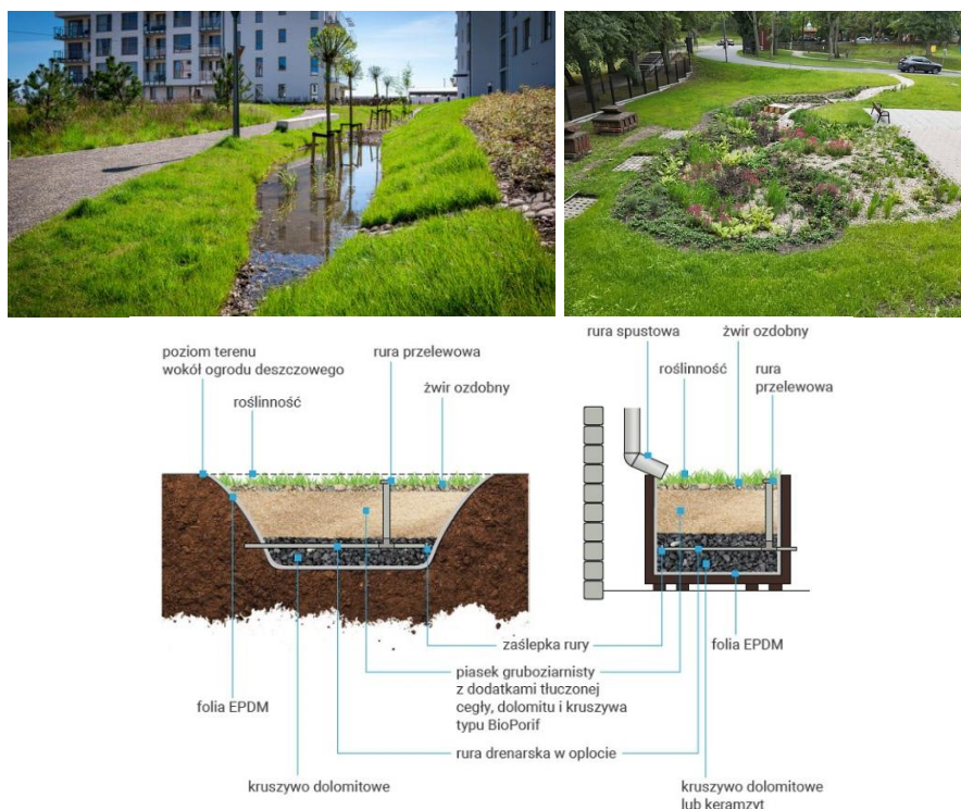
Rysunek 47. Schemat ogrodu deszczowego w gruncie i w zbiorniku [36]
